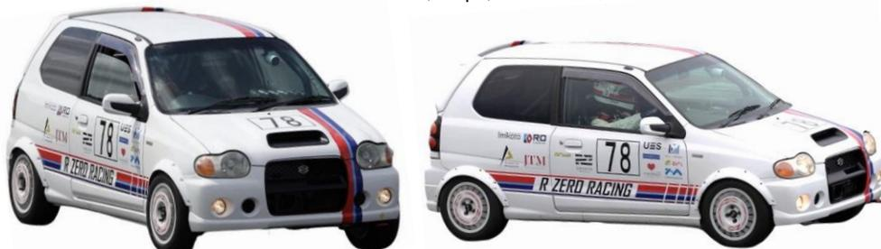
1979年に初登場したアルト。そのハッチバックにターボを追加、スポーツ仕様にしたものがアルトワークスです。軽自動車の64馬力自主規制の元になったほど当時としては非常にパワフルでした。本車両は4代目にあたるHA22S型、そのトップグレードのRS/Zで、通常「涙目ワークス」と呼称されます。エンジンは鍛造ピストンにダイナミックバランス、ハイカム化まで行い、89.5kW (120ps) までスーパアップ。ボディは極限までの軽量化が実施され、ボンネット、リアゲートはFRP、ルーフはカーボン化、まさに羊の皮をかぶった狼と言えます。
