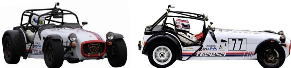
セブンは1950年代から続く量産キットカーであり、公道を走れるオープンホイールのクラブマンレーサーです。ボディやシャシーは手作りにより制作され、非常にシンプルな構造で、部品点数の削減による軽量化が図られます。当時のタイヤ性能ではこれでも十分な強度があり、無駄を排除するコーリン・チャップマンの思想がうかがえます。このセブン160も、当時の簡略・軽量のパイオニア精神を忠実に守り、スズキ製660ccターボ付きエンジンを搭載することで車重490kgとケータハムブランドの最軽量モデルとなりました。このエンジンはさらにチューニングされ、89.5kW (120ps) をも発生、まさに最速の軽自動車と言える機体です。
