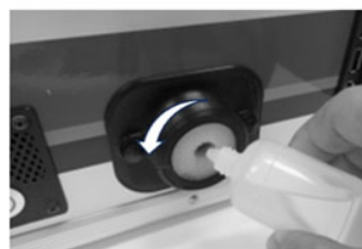
潤滑剤を注入しケースを回転
